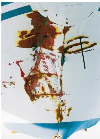
Figur 8.5 Skador på visirets front.
