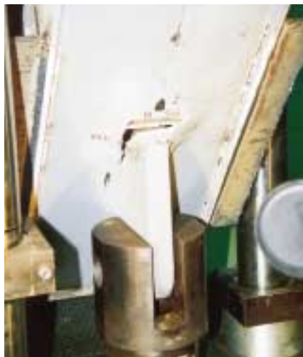
Figur 12.21 Test på fullskalemodell av sidolåsörats struktur.
