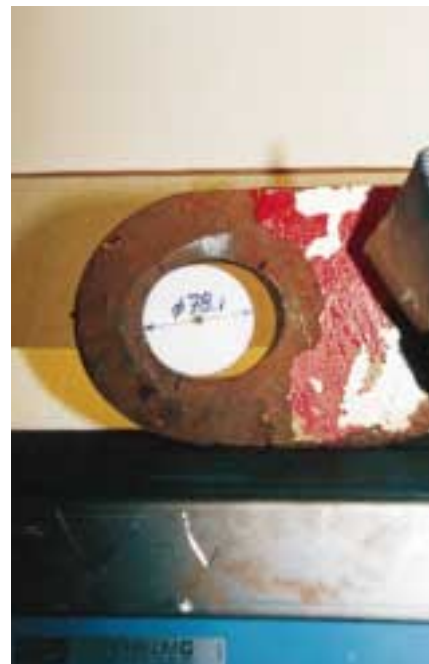
Figur 12.17 Visirörat till bottenlåset med en skiva med samma diameter som bulten införd.
