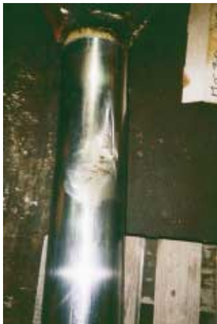
Figur 8.25 Skrapmärken på kolvstången till visirets manövercylinder på babordssidan.
