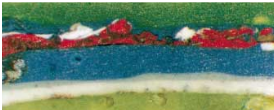
Figur 12.19 Tvärsnitt av färgprov från förpikdäckets styrbordsöra.
